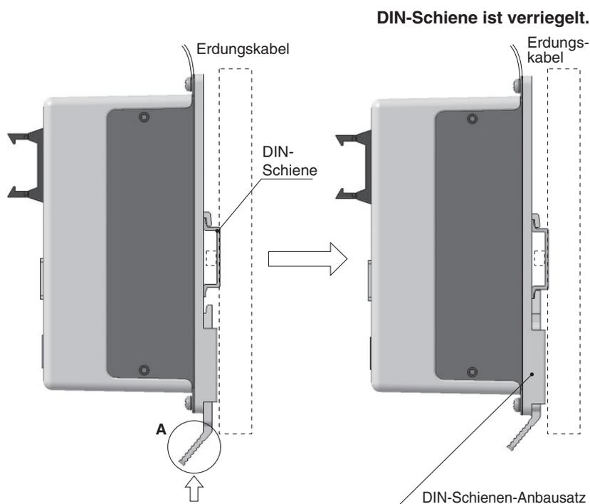
Der Controller wird in die DIN-Schiene eingehängt und zur Verriegelung wird A in Pfeilrichtung geschoben.
