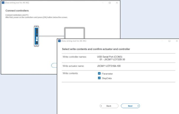
Mit dem Schreib-Tool können die Parameter und Schrittdaten des angeschlossenen Antriebs in einen unbeschriebenen Controller der Serie JXC geschrieben werden.
