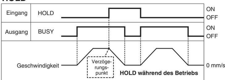
\* Wenn sich der Antrieb im Positionsbereich befindet, stoppt er auch dann nicht, wenn ein HOLD-Signal eingegeben wird.
