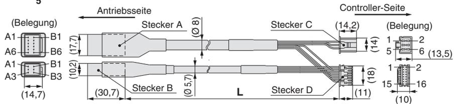
LE-CP-<sup>8B</sup>/<sub>AC</sub>/Kabellänge: 8 m, 10 m, 15 m, 20 m
