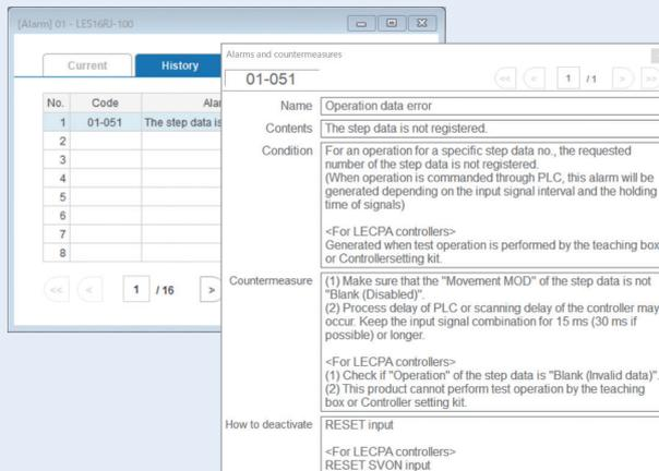
Wenn ein Alarm ausgelöst wird, können die Alarmdetails und Gegenmaßnahmen angezeigt werden.
